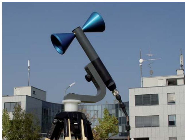
Medidas con la 9170 Biconical Antenna
